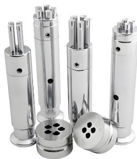
Obrázok 9 Matrica, horné a dolné razidlo tabletovacieho lisu na výrobu minitabliet 24
